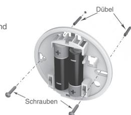
6. Befestigen Sie den Temperaturwähler auf der Montageplatte.
