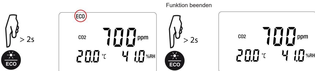
**i** Im ECO-Modus ist das Gerät empfindlicher für kurzfristige Schwankungen im CO<sub>2</sub>-Gehalt. Wenn zum Beispiel der Anwender neben dem Gerät atmet, kann dadurch das Messergebnis beeinflusst werden. Der tatsächliche CO<sub>2</sub>-Gehalt im Raum wird erst wieder mit der nächsten Messung angezeigt.
