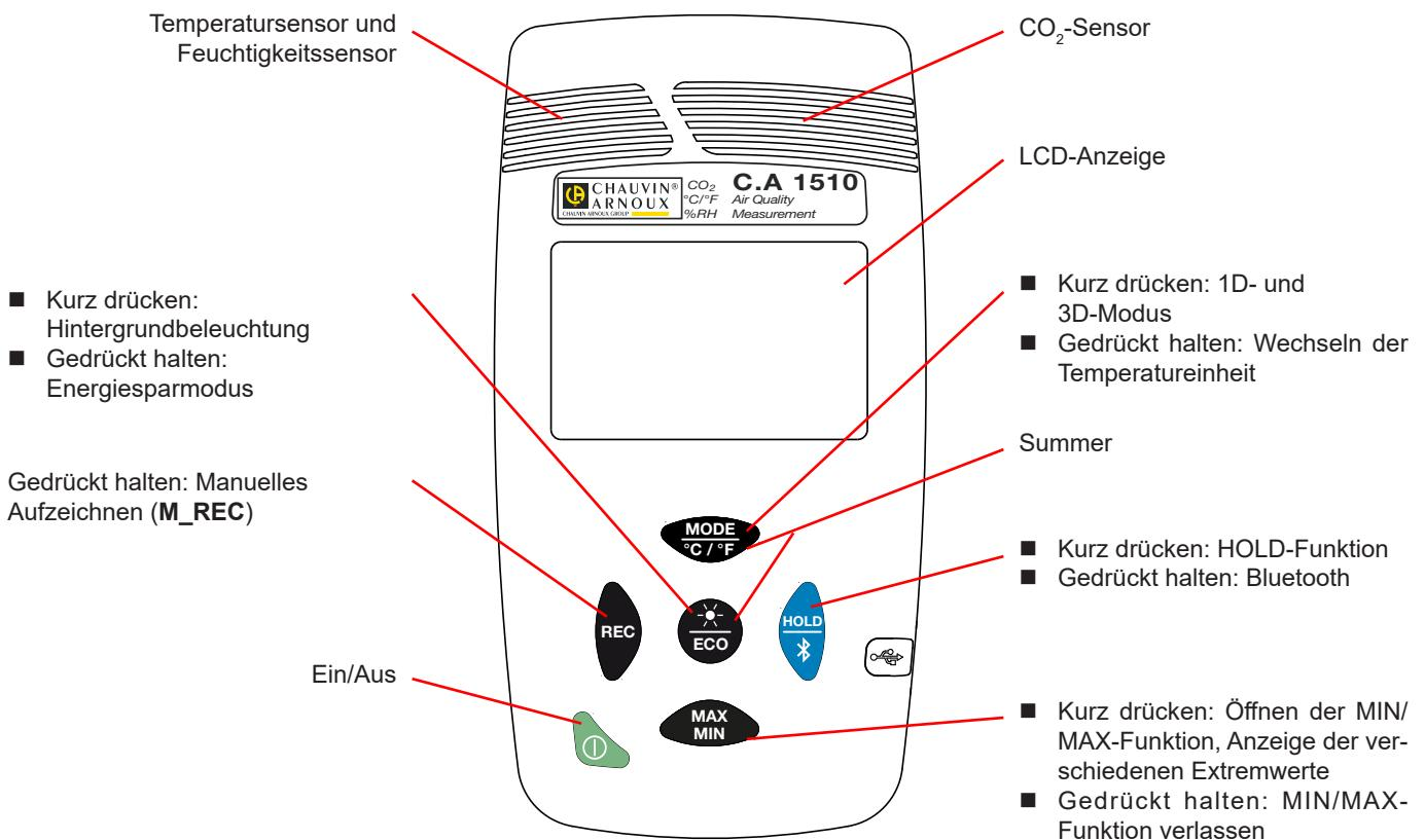
**i** Auf den Tasten steht die Funktion, die mit kurzem Drücken geöffnet wird, über dem Strich, und die Funktion, die beim gedrückt Halten geöffnet wird, unter dem Strich.
