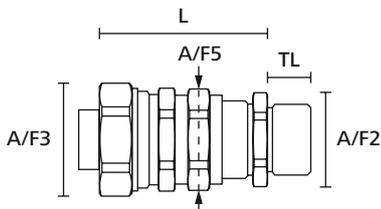
HelaGuard Kompressionsverschraubung, gerade Kabelverschraubung
