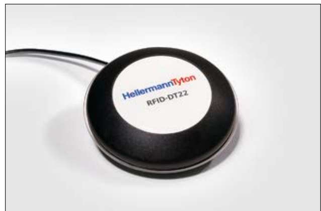
RFID-DT22 – Tischlesegerät für Hochfrequenztransponder (HF).
