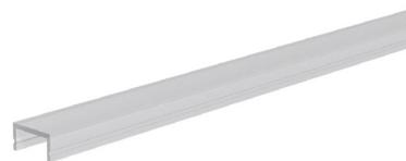
Abdeckung passend für verschiedene Aluminiumprofile. Durch die gefrostete Abdeckung sind die darunterliegenden Bauteile kaum sichtbar, während gleichzeitig bei nur geringem Lichtverlust eine Entblendung erreicht wird. Technische Daten: Material: UV-beständiges PMMA, Transmissionsgrad: ca. 80%
