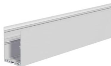
Das Aluminiumprofil dient als Trägerprofil für das Einlegeprofil APRR4. Das Einlegeprofil kann nach der Montage des APRU46 einfach von Vorne eingeklipst werden. Einsatz im Außenbereich nur bei fachgerechter Montage und Verwendung eines LED-Strips mit entsprechender Schutzart. Technische Daten: Material: Aluminium eloxiert Schutzklasse: IP20. Für das Profil können folgende Abdeckungen verwendet werden: KAMR4 und KAMRH4.
