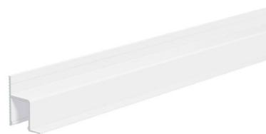
Das Wandabschlussprofil aus Aluminium bildet den bündigen Wandabschluss bei der Montage von Trockenbaudecken oder Rasterdecken und ist für LED-Strips bis 15mm Breite geeignet. Das Profil sorgt für eine optimale Beleuchtung der Wand. Das Profil ist weiß pulverbeschichtet (ähnlich RAL9003, matt). Für das Profil können folgende Abdeckungen verwendet werden: KAMF, KAMFB, KAKF und KAMH.
