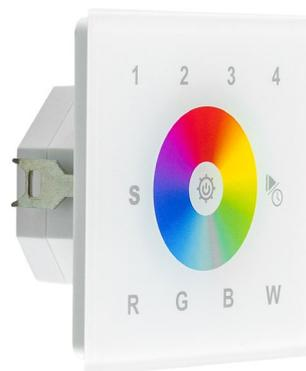
DMX-Wandpanel für die Ansteuerung der DMX-Controller. Steuerung von bis zu 4 separaten Zonen (Controllern). Für Schalterdosenmontage geeignet. Funktionen: Farbwechsel über Touch-Farbrad, Direktfarbwahl (rot, grün, blau und weiß), Ein- und ausschalten, so wie Programmwechsel. Technische Daten: ta: -20 - 50°C, tc: 75°C.
