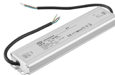
Der kurzschlussfeste Sicherheitstransformator lässt sich auf Grund der höheren Schutzart problemlos im Außenbereich einsetzen, kann aber z. B. auch beim Möbelbau verwendet werden, da die MM-Kennzeichnung gegeben ist. Die Anschlussleitungen haben eine Länge von 24cm primärseitig und 24cm sekundärseitig. Technische Daten: Versorgungsspannung: 100-240V/AC, ta: -25°C - 50°C, tc: 90°C, Powerfaktor 0,95.
