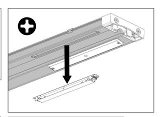
Die Leuchte kann nun in umgekehrter Reihenfolge wieder zusammengeabut und montiert werden. Achten Sie dabei auf den korrekten Sitz der Dichtungen und prüfen sie auf eventuelle Beschädigung.
