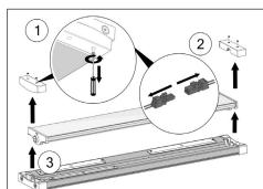
Nach dem entfernen der Abdeckung den XXL-Deckel des Anschlussraums öffnen.
