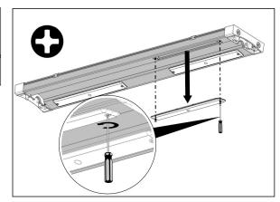
Anschliessend das Vorschaltgerät tauschen. Je nach Ausführung ist auf den korrekten Anschluss der Leitungen zu achten. Siehe dazu die Beschriftung der Anschlussklemmen des Vorschaltgerätes.
