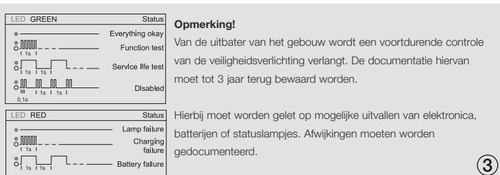
Door de optioneel mogelijke koppeling van de veiligheidsverlichtingstoestellen via de DALI-aansluiting op een overkoepelende controller (SB 128 // LITECOM) kunnen de normatief vereiste tests per kalender en klokfunctie worden gesynchroniseerd en samen vastgelegd. Met deze centrale functie wordt een complex, handmatig bij te houden testboek overbodig.
