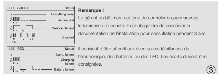
Grâce à la possibilité en option de raccorder les luminaires de sécurité via le port DALI à un contrôleur supérieur (SB 128 // LITECOM), les tests exigés par la norme peuvent être synchronisés via la fonction de calendrier et d'horloge et consignés conjointement. Cette fonction centrale permet de renoncer à un rapport d'essai manuel et laborieux.
