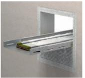
Mineralfaserplatten (Dicke ≥ 60 mm) passend zuschneiden, die umlaufenden Kanten zur Verklebung mit FLAMRO® BMA beschichten und anschließend 1-lagig in die Öffnung einbringen.
