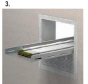
Mineralfaserplatten (Dicke ≥ 60 mm) passend zuschneiden, die umlaufenden Kanten zur Verklebung mit FLAMRO® BMA beschichten und anschließend 1-lagig in die Öffnung einbringen
