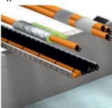
Elektroinstallationsrohre und PE-Leitungen "speed pipes" mit Brandschutzwickel PYRO-SAFE® DG-CR 1.5 umwickeln. Hohlleiterkabel mit Mineralfasermatten isolieren.
