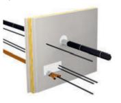
Kabelbündel mit Brandschutzwickel PYRO-SAFE® DG-CR 1.5 umwickeln.
