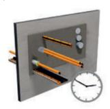
Den Mörtel für mindestens 10 Minuten abbinden lassen. Anschließend die Oberfläche mit einer Kelle (evtl. etwas Wasser) glätten und ggf. Schwindrisse nacharbeiten. 2.
