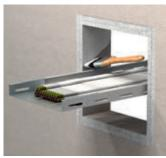
Durchgeführte Kabel und Kabeltrassen im Schottbereich und ≥ 100 mm je Seite mit FLAMRO® BMA beschichten (TSD ≥ 1 mm).
