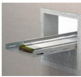
Durchgeführte Kabel und Kabeltrassen zu beiden Seiten mit FLAMRO® BMA (Länge ≥ 200 mm: 100 mm TSD ≥ 3 mm + 100 mm TSD ≥ 1 mm) beschichten.
