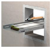
Durchgeführte Kabel und Kabeltrassen im Schottbereich und ≥ 100 mm je Seite mit FLAMRO® BMA beschichten (TSD ≥ 2 mm).
