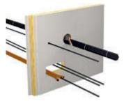
Bauteillaibung reinigen, ggf. Laibung beplanken.
