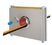
Ringspalt mit Brandschutzmörtel verschließen. In leichter Trennwand auf 25 mm Tiefe, in Massivbauteilen auf ganzer Tiefe.
