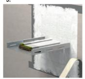
Die Oberfläche der Abschottung mit FLAMRO® BMA beschichten (TSD ≥ 1 mm). Um hindurchgeführte Installationen ist ein ca. 30 mm breiter Streifen so zu beschichten, dass die TSD ≥ 2 mm beträgt.
