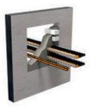
Brandschutzmasse hohlraumfrei so in die Öffnung einbringen, dass ein fester, dichter Anschluss zum Bauteil entsteht. Zwischenräume und Zwickel dabei vollständig ausfüllen.
