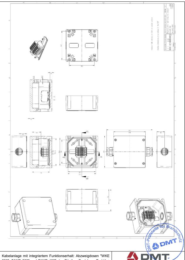
200", "WKE 300" und "WKE 400" der Günther Spelsberg GmbH + Co. KG zur Verwendung in Kabelanlagen mit integriertem Funktionserhalt
