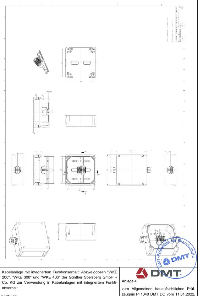
WKE 400: Zeichnung der Abzweigdose zeugnis P-1040 DMT DO vom 11.01.2022, geändert am 06.06.2023
