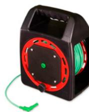
Verlängerungsleitung 30 m, grün, auf praktischer Kabeltrommel, doppelt isolierte Silikonleitung, ideal für die Isolationsmessung, sowie zur Messung von Schutz- und Potentialausgleichsleiter, Strombelastung max. 20 A, Anschluss: Ø 4 mm Sicherheitsprüfbuchse / -stecker
