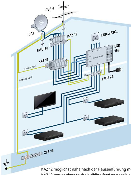
KAZ 12 möglichst nahe nach der Hauseinführung montieren = LPZ 0A
