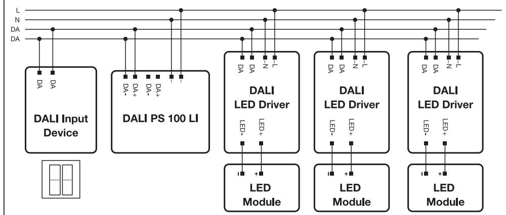
Wiring scheme / Anschluss-Schema<sup>11)</sup>
