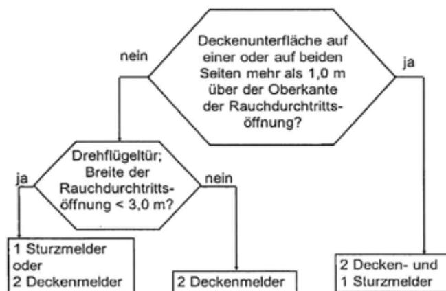
Bild 3: Entscheidungsdiagramm
