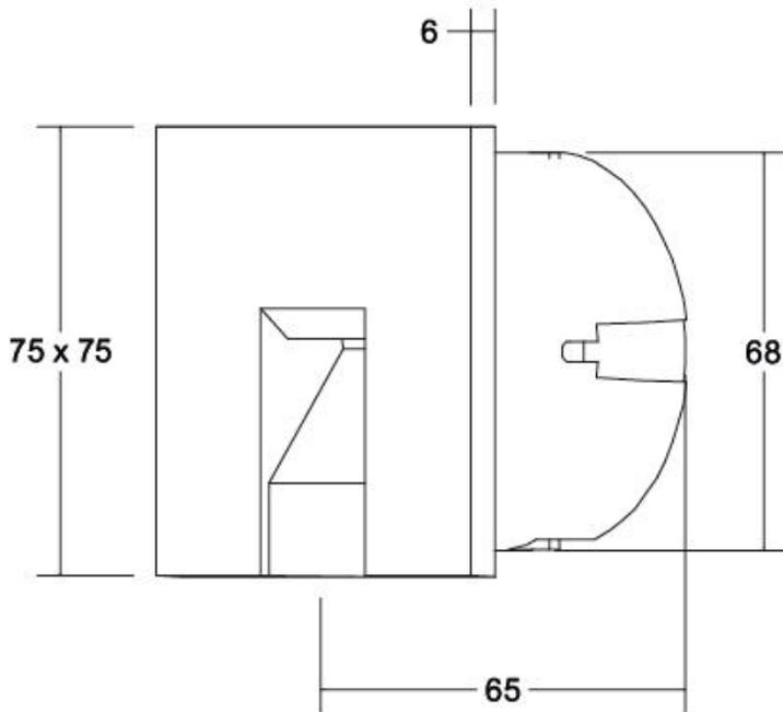
Abbildung mit Kaiser-Gerätetdose 9064-02. Diese ist im Lieferumfang nicht enthalten.
