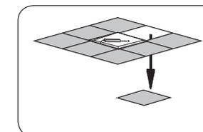
Entfernen Sie ein Deckenpaneel neben dem LED-Panel.
