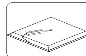
Platzieren Sie das Netzgerat auf der Ruckseite des Panels.
