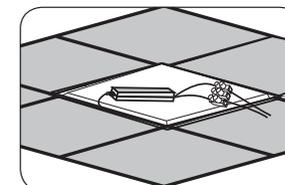
Schlieen Sie den LED-Treiber an das Stromnetz an. Ersetzen Sie das Deckenpaneel, um die Installation abzuschlieen.
