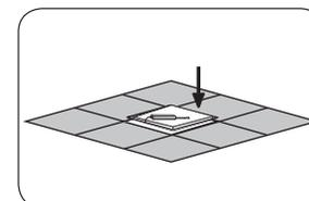
Stellen Sie sicher, dass die Platte gleichmaig innerhalb des T-Bar-Deckengitters sitzt.
