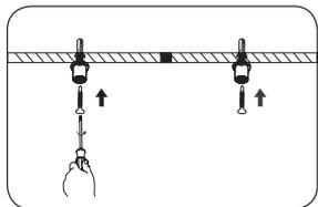
Stecken Sie die Dübel in die Decke und befestigen Sie die Aufhängeflächenbefestigung an der Decke.
