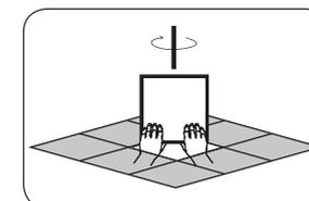
Drehen Sie das Panel, um es leicht in das Deckenraster einzufuhren.
