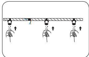
Schrauben Sie das Aufhängekabel an die Deckenbefestigung.
