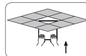
Setzen Sie das LED-Panel in das Deckenraster ein.
