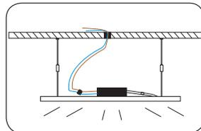
Schließen Sie den LED-Treiber an das Stromnetz an.
