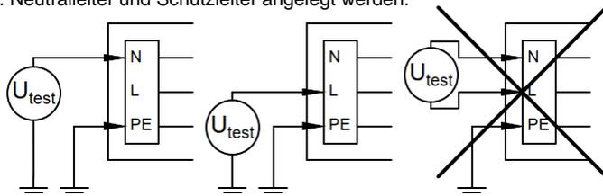
Nach abgeschlossener Isolationsprüfung ist die einwandfreie Leiterverbindung zwischen Netz und Beleuchtungsanlage wieder herzustellen. Vor Inbetriebnahme ist der feste Anschluss des Neutralleiters sicherzustellen, um nicht das Vorschaltgerät durch unzulässige Überspannung bei unsymmetrischer Netzbelastung zu schädigen (siehe hierzu Abschnitt 5.2).
