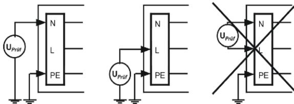
Nach abgeschlossener Isolationsprüfung ist die einwandfreie Leiterverbindung zwischen Netz und Beleuchtungsanlage wieder herzustellen. Vor Inbetriebnahme ist der feste Anschluss des Neutralleiters sicherzustellen, um das Vorschaltgerät durch unzulässige Überspannung bei unsymmetrischer Netzbelastung nicht zu schädigen (siehe hierzu Abschnitt 5.2).
