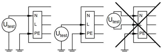
Vorschaltgerät durch unzulässige Überspannung bei unsymmetrischer Netzbelastung zu schädigen (siehe hierzu Abschnitt 5.2).
