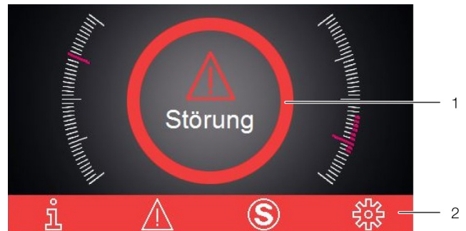
Abb. 36: Bildschirm bei Auftreten einer Störung
