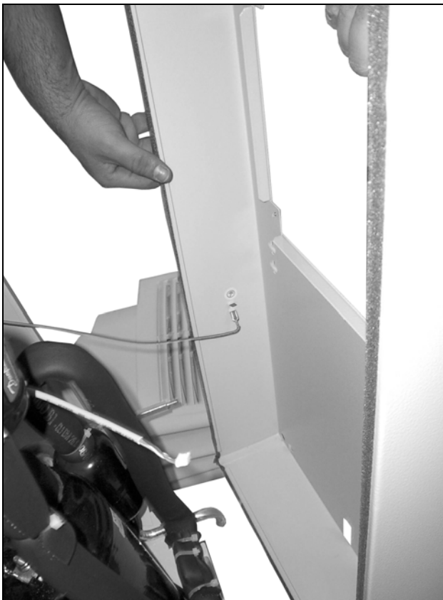
Obr. 72: Odpojení uzemňovacího kabelu (1)
