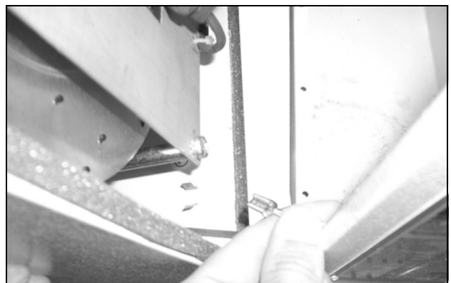
Obr. 50: Uvolnění uzemňovacího kabelu mezi krytem a chassis (2)
