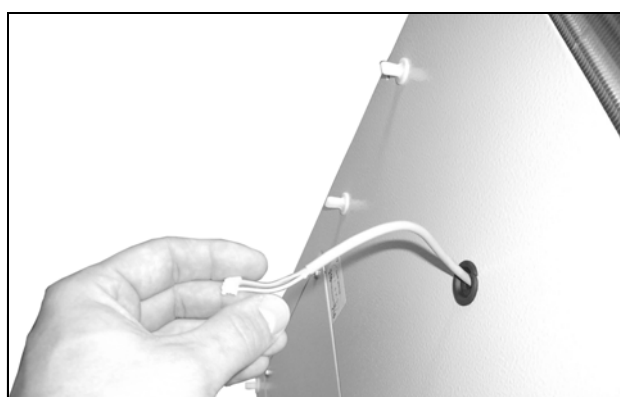
Obr. 45: Zasunutí kabelu displeje
