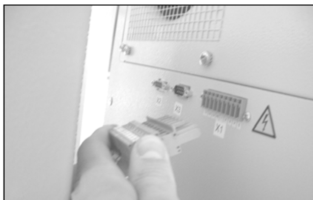
Obr. 34: Odpojení napájecího konektoru
