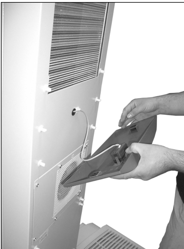
Obr. 59: Odstranění držáku displeje
