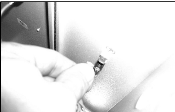
Obr. 69: Odpojení uzemňovacího kabelu ventilátoru (2)
