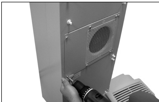
Obr. 63: Uvolnění čtyř šroubů ventilátoru vnějšího okruhu
