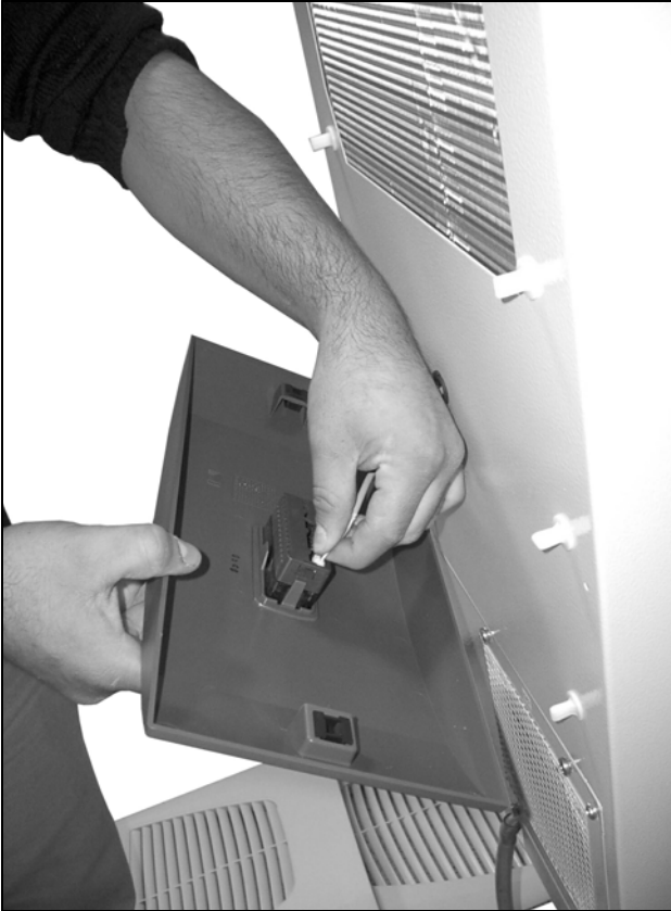
Imagen 38: Desconectar el display (1)
