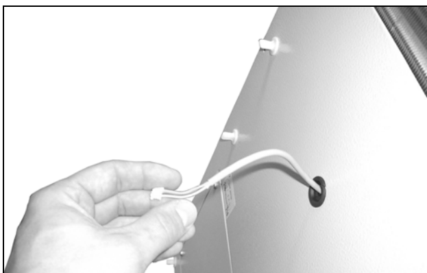
Imagen 45: Retirar el cable del display
