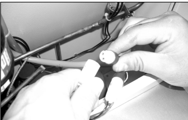
Imagen 67: Desconectar el ventilador (3)
