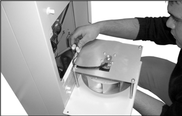
Imagen 65: Desconectar el ventilador (1)
