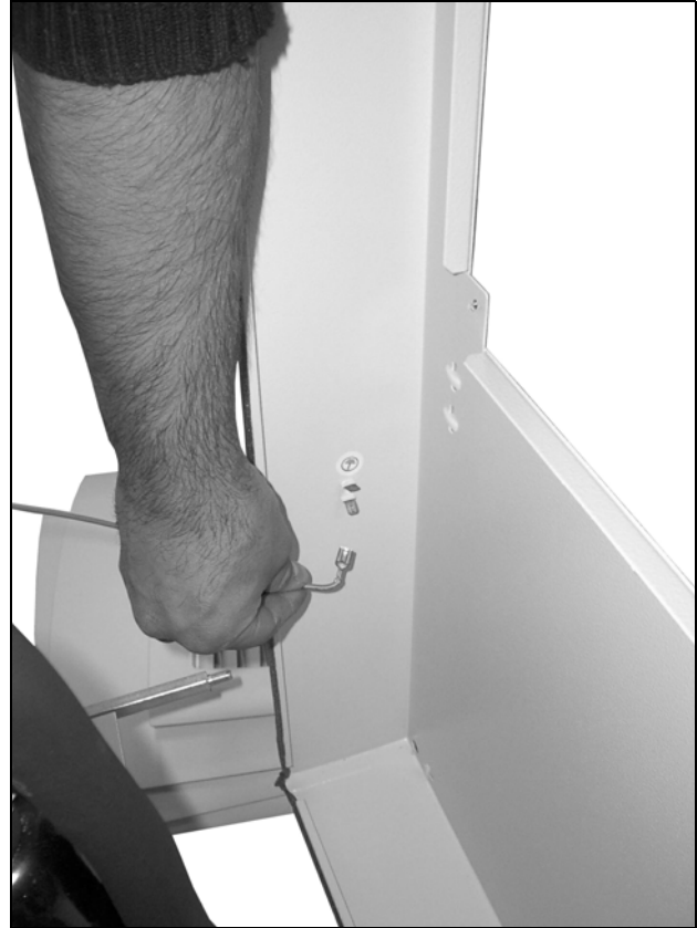
Imagen 73: Desconectar el cable de puesta a tierra (2)
