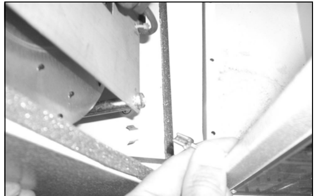
Şek. 50: Başlık ile şasi arasındaki topraklama kablosunu çözün (2)
