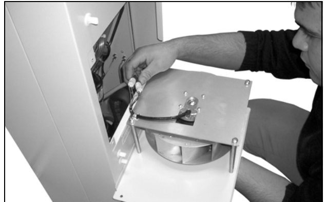
Şek. 65: Fanın konektör bağlantısını çıkarın (1)
