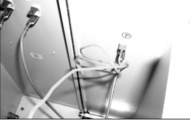
Şek. 68: Fanın topraklama kablosunu çıkarın (1)
