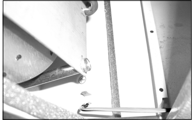
Şek. 49: Başlık ile şasi arasındaki topraklama kablosunu çözün (1)
