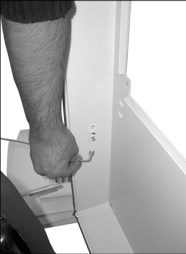
Şek. 73: Topraklama kablosunu çıkarın (2)
