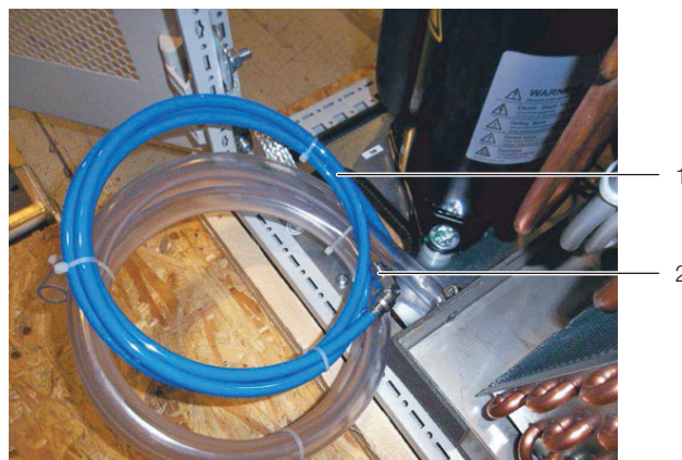
Рис. 46: Шланг с элементом подключения, наружная резьба 1/8"
