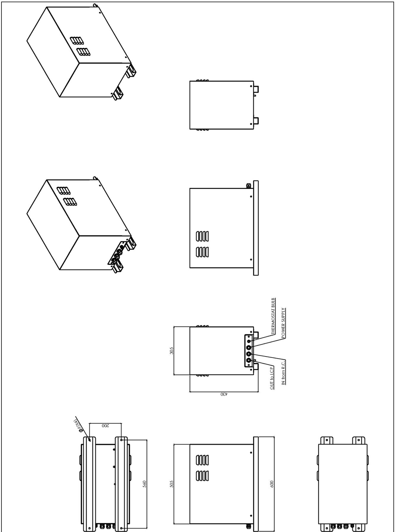
Abb. 70: Aufstellplan der Hydraulikbox (Niedertemperatur Unit)
