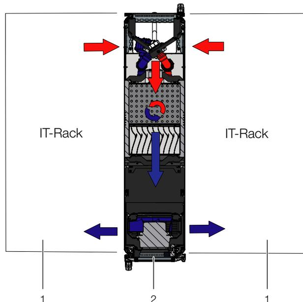
Abb. 5: Luftführung bei zwei angereihten Serverschränken – Draufsicht
