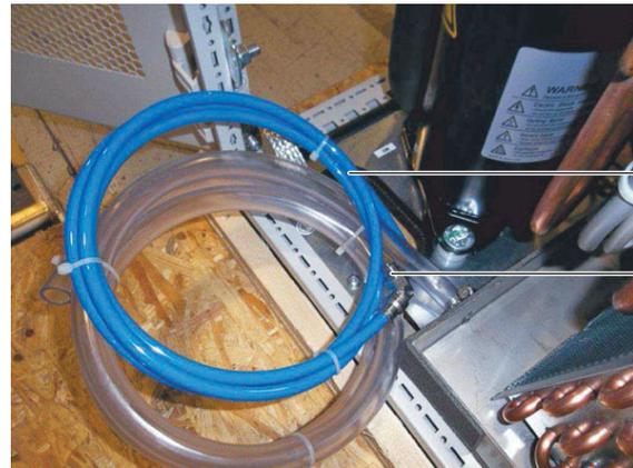
Abb. 48: Anschlusschlauch mit Anschlussstück 1/8" Außengewinde
