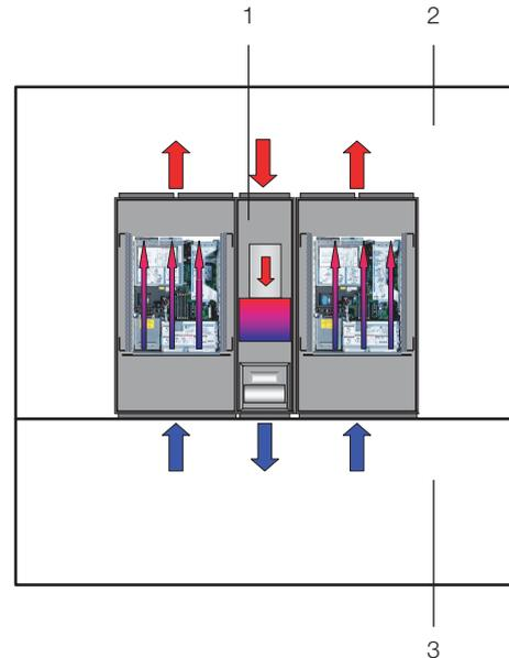
Abb. 13: Aufstellraum mit Kaltgang-Schottung
