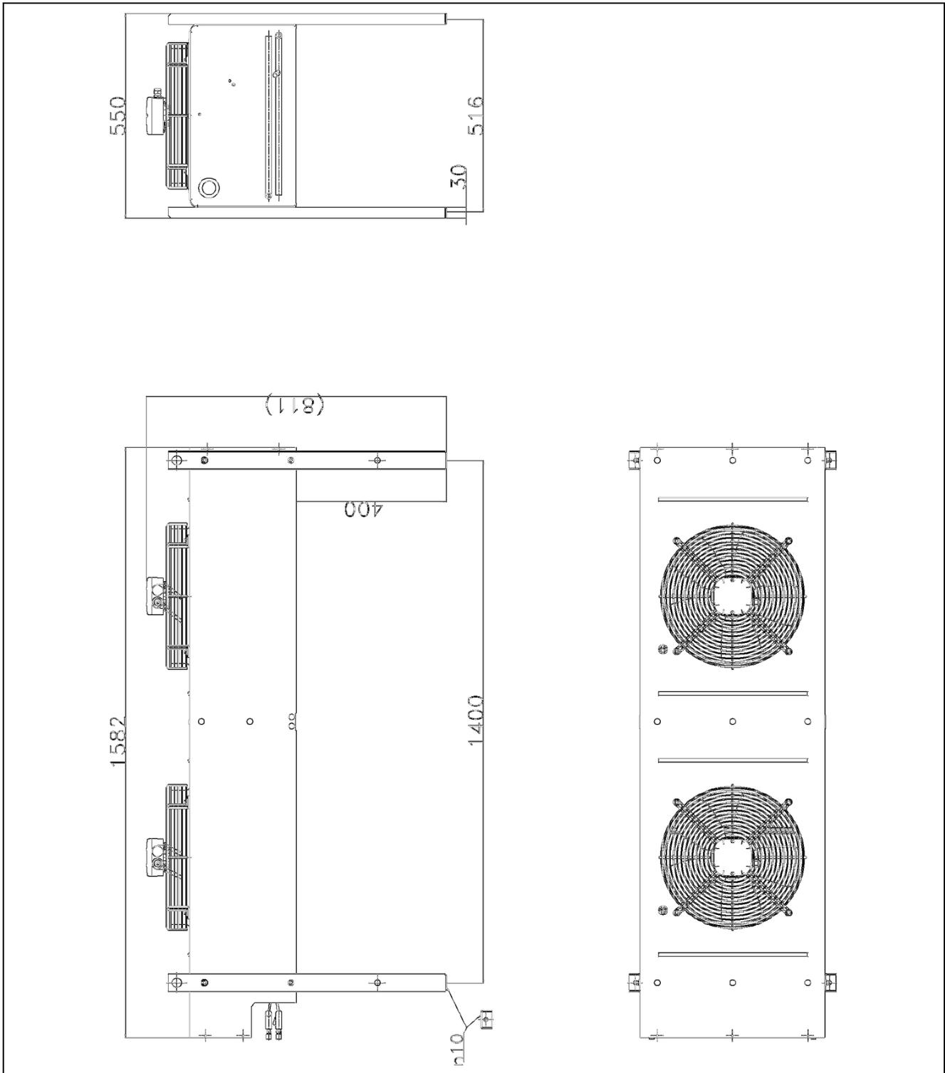
Abb. 69: Aufstellplan des Niedertemperatur-Verflüssigers (Niedertemperatur Unit)
