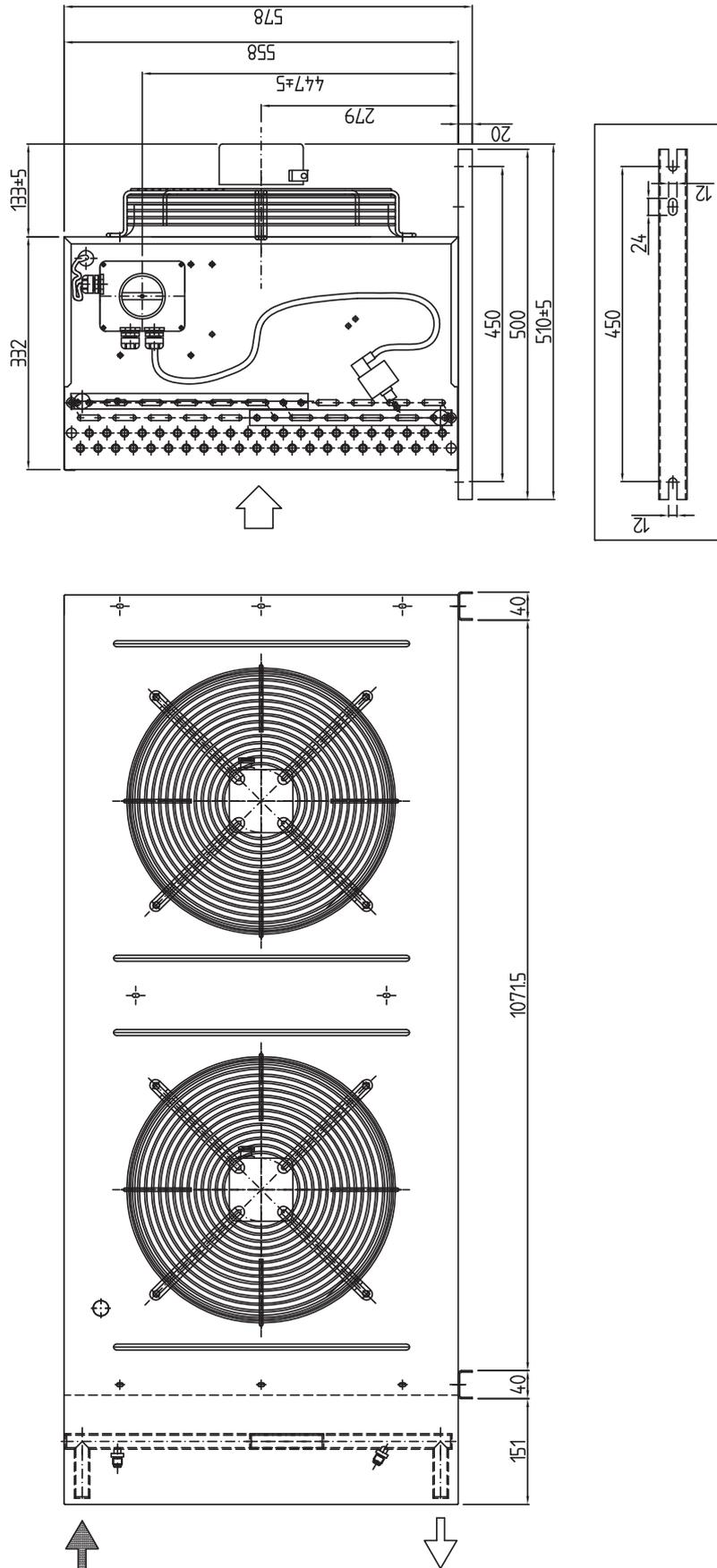
Abb. 66: Standard-Verflüssiger 3311.360 (Fassadenmontage)
