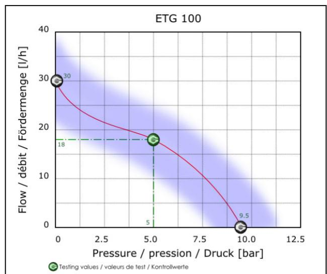
Abb. 56: Leistungsdigramm der Kondensatpumpe
