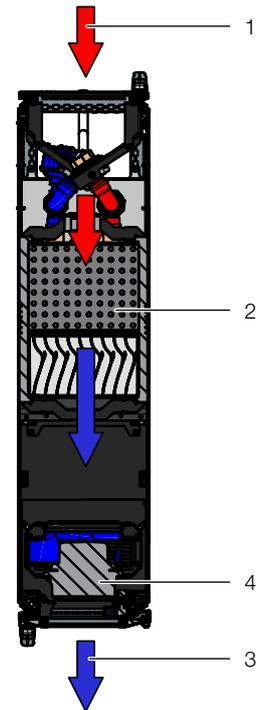
Abb. 2: Luftführung am LCP Inline DX – Draufsicht
