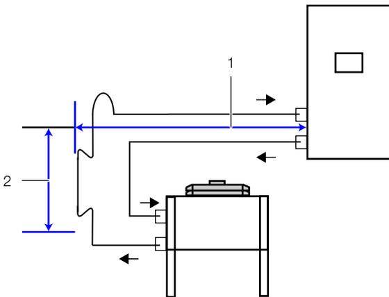
Abb. 8: Relative Positionierung Verflüssiger unterhalb LCP DX
