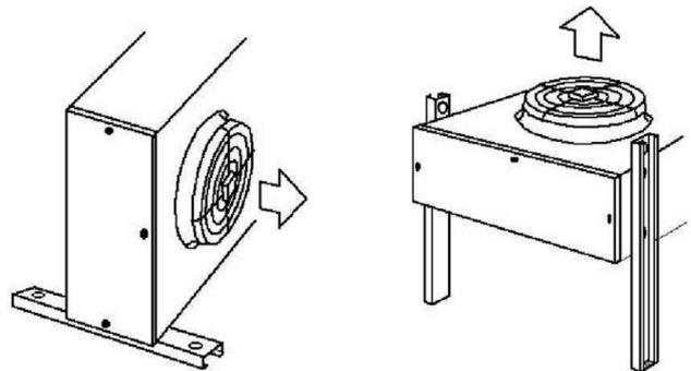
Abb. 16: Horizontale oder vertikale Montage
