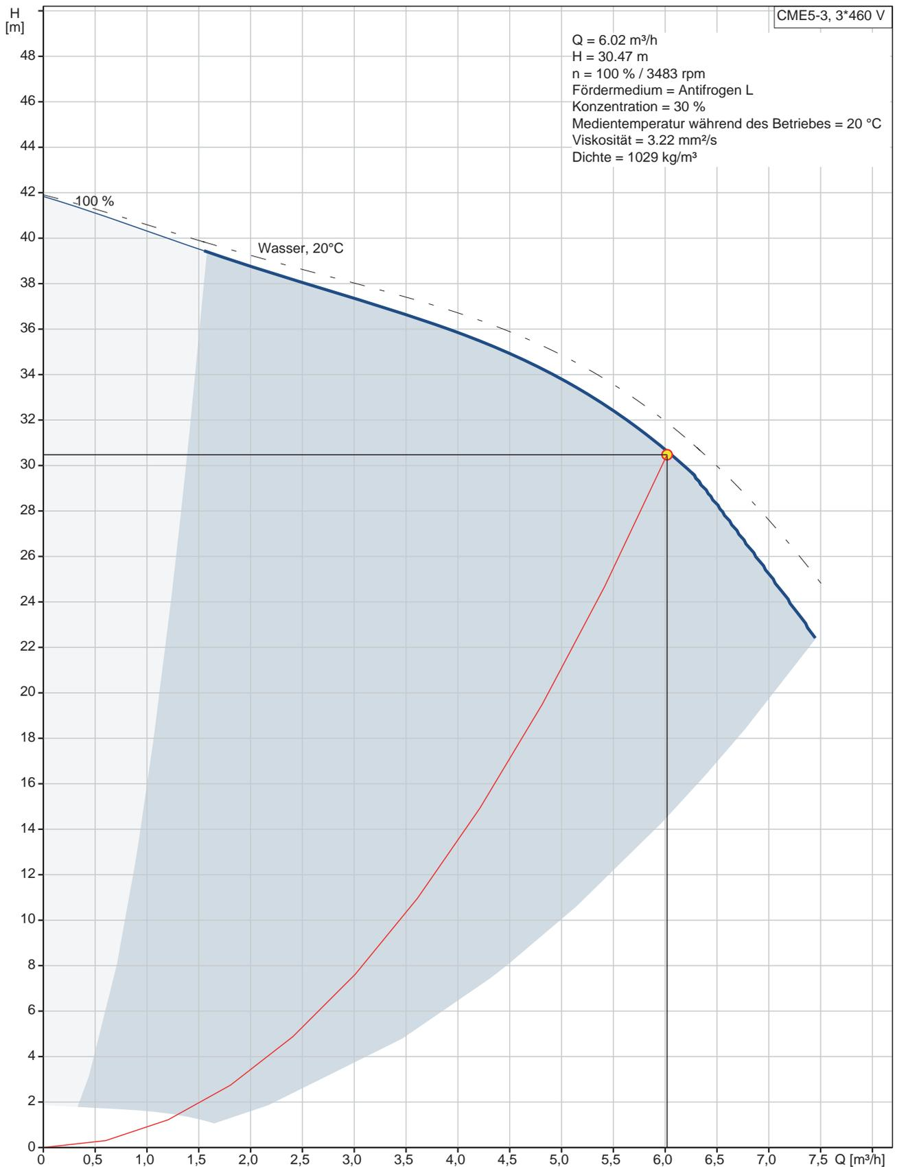
Abb. 79: Kennlinie Kühlwasserpumpe
