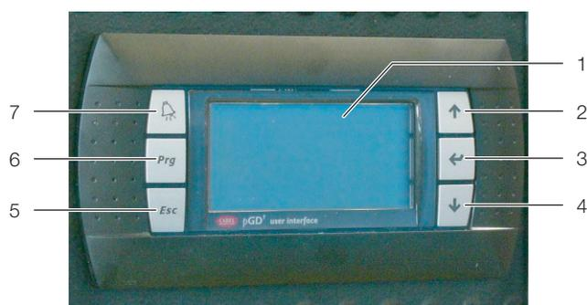
Abb. 32: Bedien- und Anzeigeelemente
