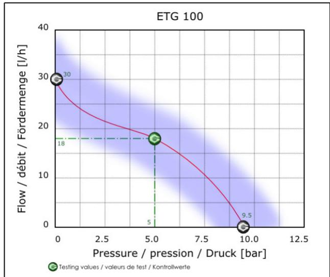
Abb. 58: Leistungsdiagramm der Kondensatpumpe
