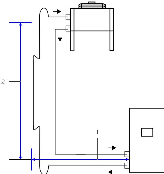
Abb. 9: Relative Positionierung Verflüssiger oberhalb LCP DX
