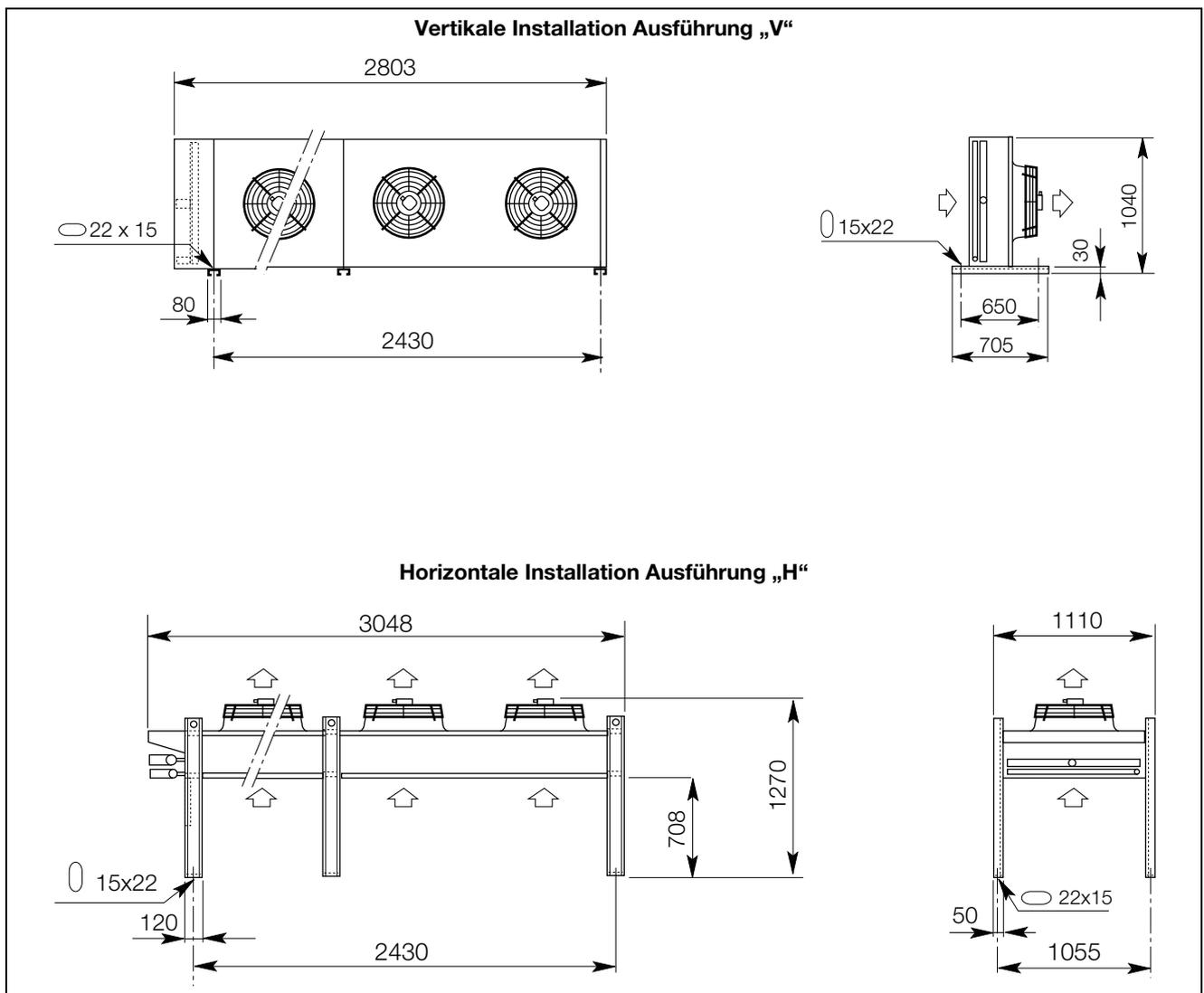
Abb. 69: Aufstellplan des Verflüssigers zur indirekten Freikühlung (3311.380)
