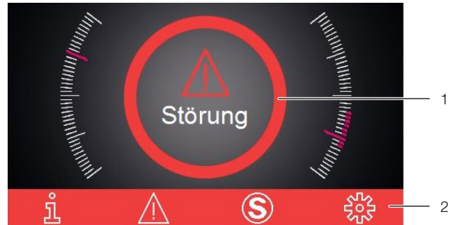
Abb. 44: Bildschirm bei Auftreten einer Störung
