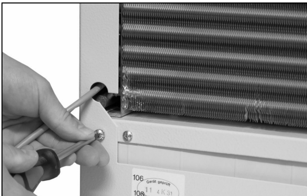
Fig. 26: Retirar os parafusos de fixação da tampa (soltar os quatro parafusos)
