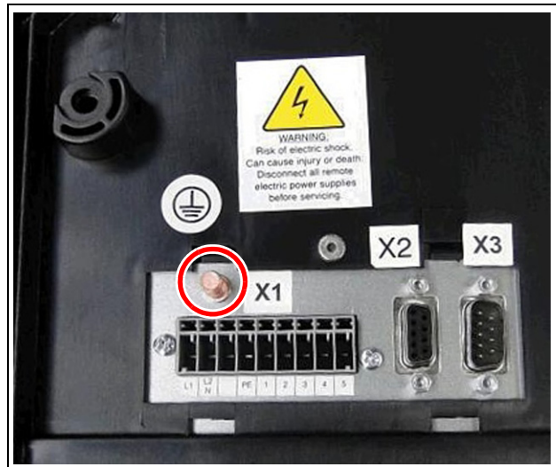
Rys. 11: Złącze wyrównania potencjałów
