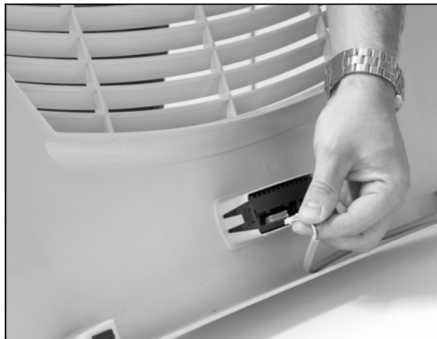
Rys. 24: Odłączanie wtyczki od wyświetlacza
