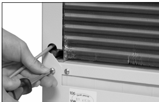
Rys. 26: Demontaż śrub mocujących pokrywy (poluzować cztery śruby)
