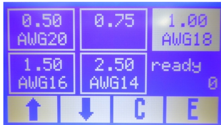
Fig. 15 : écran tactile, affichage du menu de sélection
