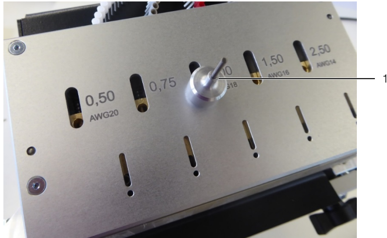
Fig. 8 : broche de fixation en haut
