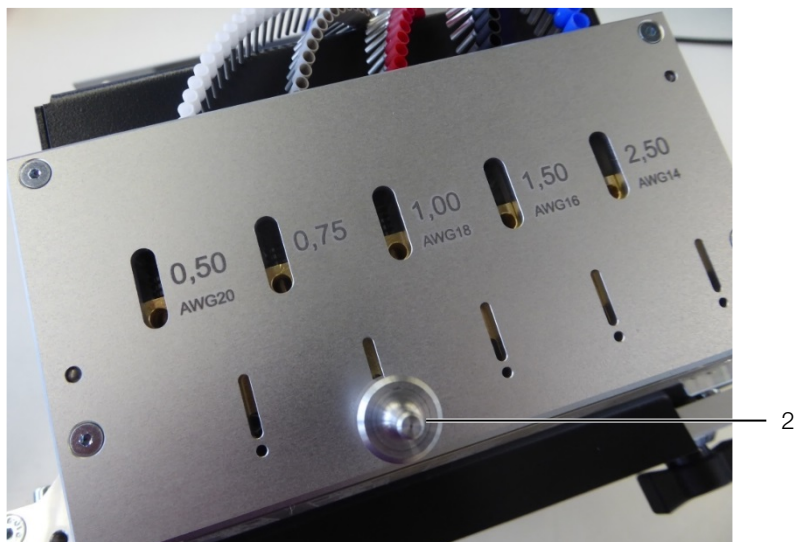
Fig. 7 : broche de fixation en bas
