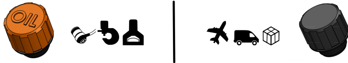
Obr. 3: Výměna šroubu uzávěru nebo odvzdušňovacího šroubu (znázornění jako příklad)
