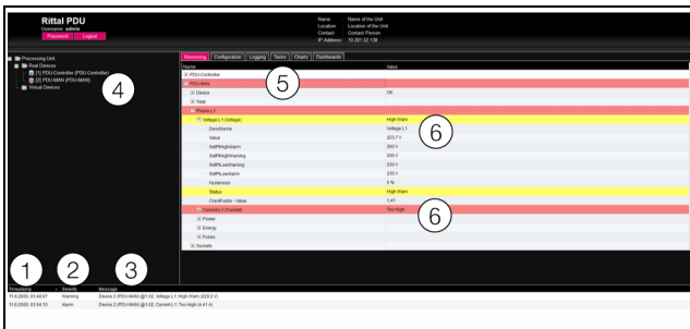
Abb. 42: Aufbau der Meldungsanzeige
