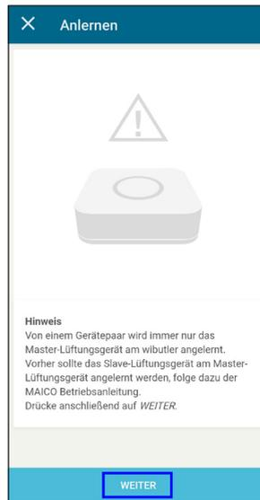
12. Zum Starten des Einlernmodus halten Sie die LEARN-Taste auf der Vorderseite des Master-Lüftungsgeräts gedrückt, bis alle LEDs am Lüfter zu blinken beginnen (ca. 2 Sekunden). Danach bestätigen Sie mit „**WEITER**“.
