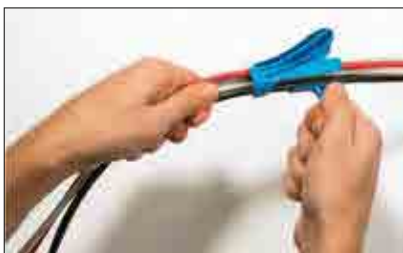
Kabelbündel seitlich in das Aufziehwerkzeug legen.
