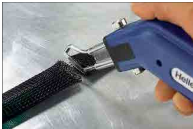
Das Ausfransen beim Schneiden eines Geflechtschlauchs lässt sich mit dem HSG0 vermeiden.
