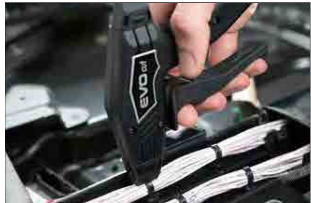
Der Kabelbinnder kann an beliebiger Stelle durchtrennt werden.
