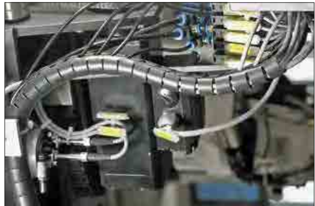
Flexibel auf ganzer Länge - Kabelabzweigungen an jeder Stelle möglich.
