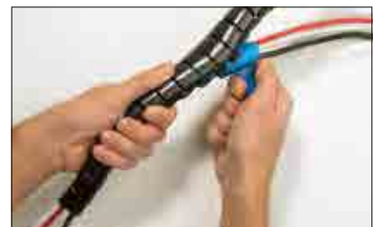
Helawrap wird nun nach dem Reißverschlussprinzip montiert.
