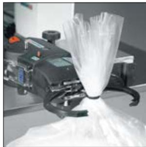
Anwendungsbeispiel: Verschließen von Beuteln mit Montagevorrichtung horizontal 3080.
