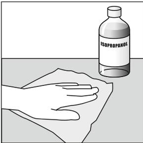
1. Die Oberflächen müssen trocken, frei von Staub, Öl, Oxiden, Trennmitteln und anderen Verunreinigungen sein. Die zu verklebende Oberfläche ist mit einem sauberen Tuch und Isopropanol / Wasser (50/50) zu reinigen. Bei Verwendung anderer geeigneter Reinigungsmittel ist darauf zu achten, dass die Oberfläche nicht angegriffen wird und keine Rückstände hinterlassen werden. Nach der Reinigung die Oberfläche unbedingt an der Luft vollständig trocknen lassen.
