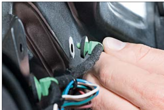
Die zusätzliche Dichtung schützt vor eindringender Feuchtigkeit.
