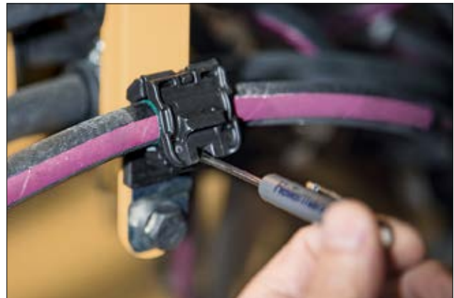
Ratchet P-Clamp - Eine vielseitige Art, Kabel zu montieren und zu befestigen.
