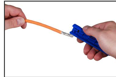
3. Werkzeug öffnen, isolation händisch abziehen
