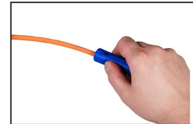
2. Mantel durch eine Drehung anschneiden
