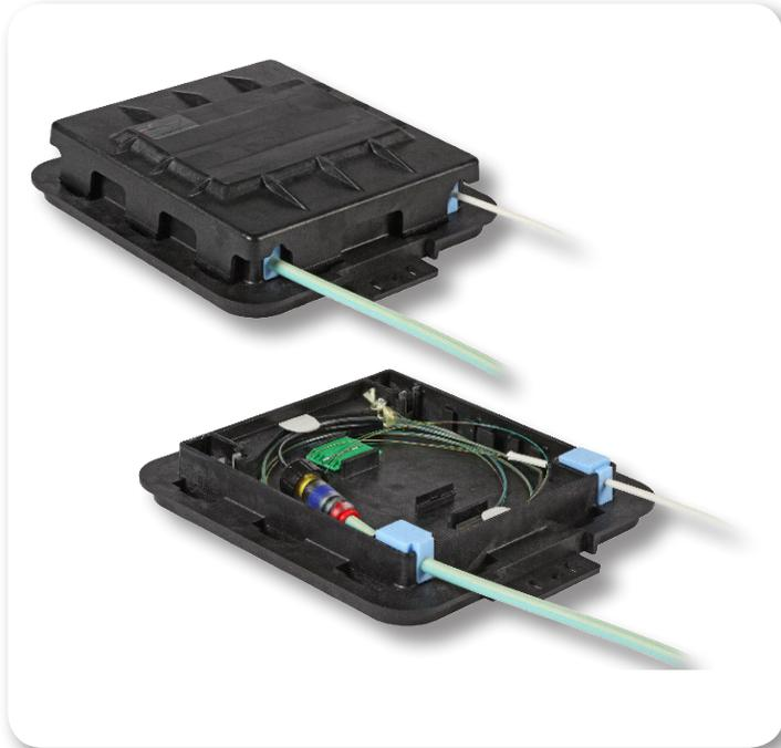
Das Design der Muffe ist so konstruiert, dass sie als End- und/ oder Durchgangsmuffe genutzt werden kann. Dabei kann die Muffe direkt erdverlegt werden, aber auch im Kabelschacht sowie in Mast- oder Wandmontage installiert werden.
