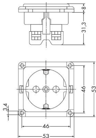
**Compacta Steckdose SCHUKO Einbau
