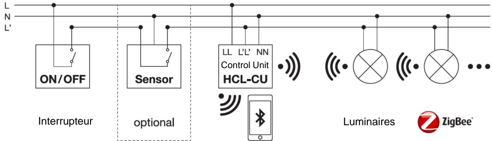
La connexion entre les luminaires et le contrôleur se fait grâce à l'app Biolux. Voir p. 12
