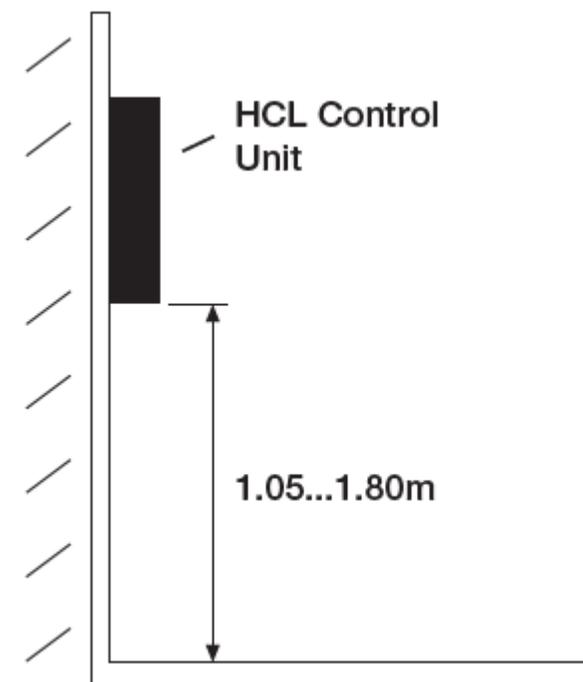
Placer le contrôleur entre 1.05 et 1.80 m de hauteur
