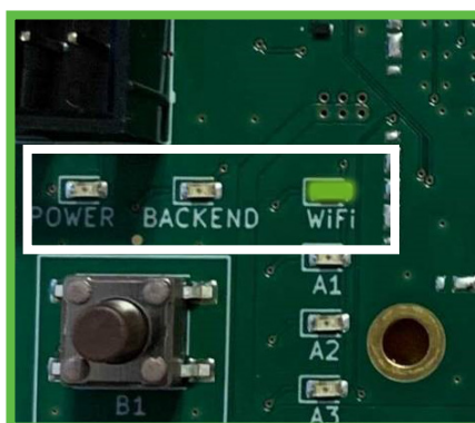
Imagen 17 LED indicadores de estado durante la puesta en servicio vía WIFI
