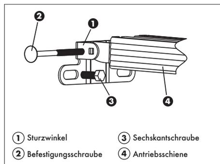
**2.** Der Sturzwinkel (1) muss genau mittig über dem Tor montiert werden. Zeichnen Sie die Position im Vorfeld genau an und bohren Sie die Löcher wenn nötig vor. Fixieren Sie den Winkel dann entweder mit den beiliegenden Sechskant-Blechschräben 6x15mm oder den Dübelschrauben 8x60mm.
