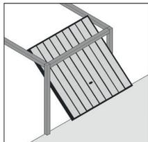
Die maximale Höhe für Schwingtore beträgt 2500mm.
