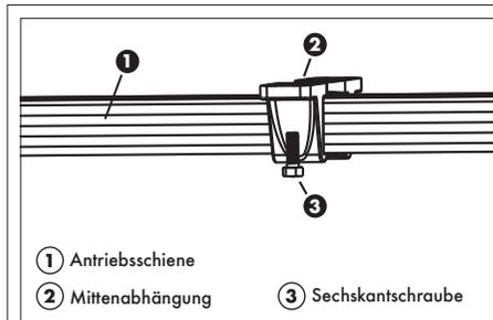
**5.** Die zusätzliche zweiteilige Abhängung (2) kann bei Bedarf mittig zwischen Tor und Antriebskopf an der Antriebsschiene (1) befestigt werden. Verwenden Sie hierzu die beiden beiliegenden Teile der Mittenabhängung (2) und Sechskantschrauben (3). Hängen Sie hierzu die beiden zusätzlichen Abhängungen mit Hilfe des zweiten Lochbands von der Decke ab. Bitte achten Sie zwingend darauf, dass kein Bauteil den fahrenden Schlitten behindert.
