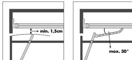
**WICHTIG:** Die Antriebsschiene muss zwingend genau mittig über dem Tor verlaufen.
