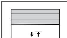
Drücken Sie kurz die Taste **+**. Der Antrieb fährt nun erst in die obere und dann in die untere Endlage. Sobald der Antrieb
