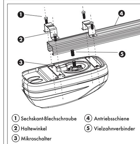
Sind alle drei Sektionen der Antriebsschiene sauber miteinander verbunden, wird im Folgenden der Antriebskopf auf der Antriebsschiene (4) montiert. Hierfür stecken Sie zunächst den Vielzahnverbinder (5) in die dafür vorgesehene Stelle des Antriebskopfes. Anschließend führen Sie diesen mit dem Verbinder passend in das Kettenritzel der Antriebsschiene ein.
