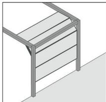
Die maximale Höhe für Sektionaltore beträgt 2175mm.
