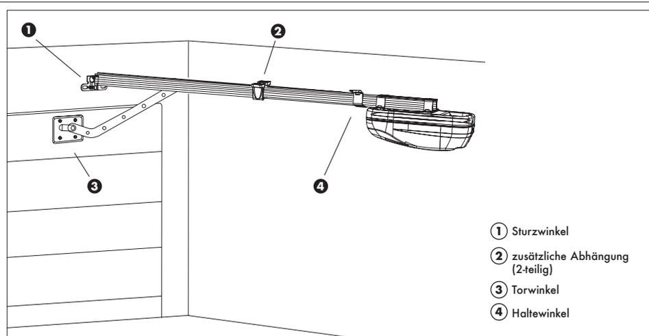
**1.** Ist der Antriebskopf auf der Schiene sicher verschraubt muss zunächst der Sturzwinkel (1) am Sturz oder an der Decke, jedoch zwingend genau mittig über dem Tor montiert werden. Nutzen Sie hierfür die beiliegenden Schrauben (8 x 60mm).
