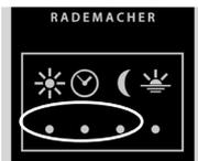
En función de la velocidad ajustada del motor, se ilumina en rojo uno de los tres LED.
