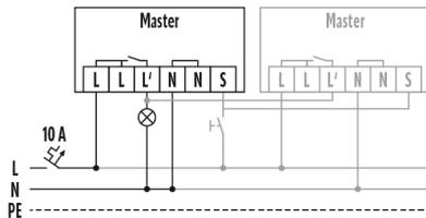
Standardbetrieb mit optionaler Ansteuerung durch Schließaster und Parallelschaltung von max. 6 Geräten
