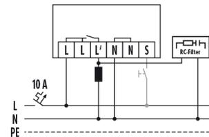
Bei Schaltung von Induktivitäten (z. B. Relais, Schütze, Vorschaltgeräte) kann der Einsatz eines Löschgliedes (RC-Filter) erforderlich sein.
