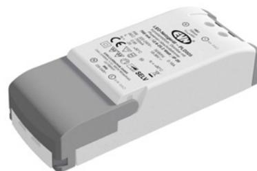
Der kurzschlussfeste Sicherheitstransformator kann problemlos beim Möbelbau zum Einsatz gebracht werden, da die MM-Kennzeichnung gegeben ist. Der Anschluss primärseitig und sekundärseitig erfolgt durch Schraubklemmen, welche für Kabel von 0,75mm<sup>2</sup> - 2,5mm<sup>2</sup> geeignet sind. Technische Daten: Versorgungsspannung: 220-240V/AC, ta: -20°C - 50°C, tc: 80°C, Powerfaktor 0,95.
